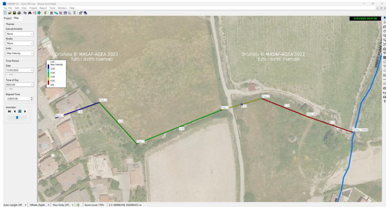
Figura 16 : Massima velocità registrata in condotta espressa in m/s
