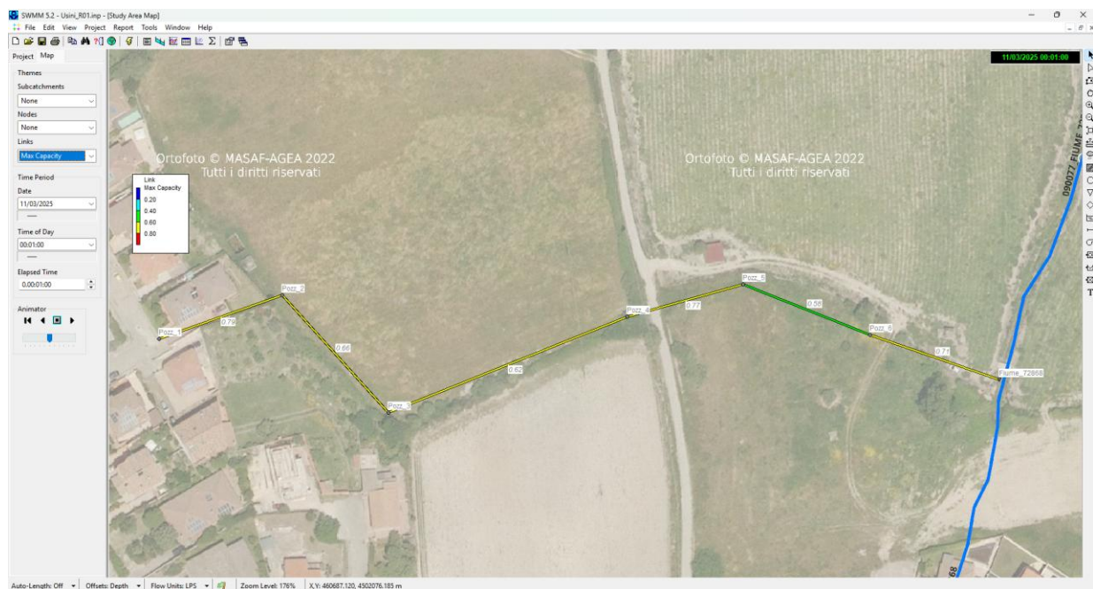
Figura 17 : Massimo grado di riempimento in condotta
